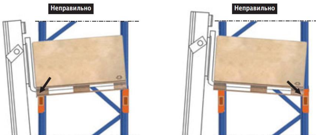
Перегрузка балки в результате негоризонтальной установки груза.
